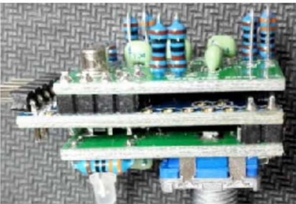
OSC 基板を Arduino 基板の裏面に重ねます。ボード間でハンダ面の接触ショートのないことを確認、浮きのないようにしてはんだ付けします。はみ出たピンをカットします。
