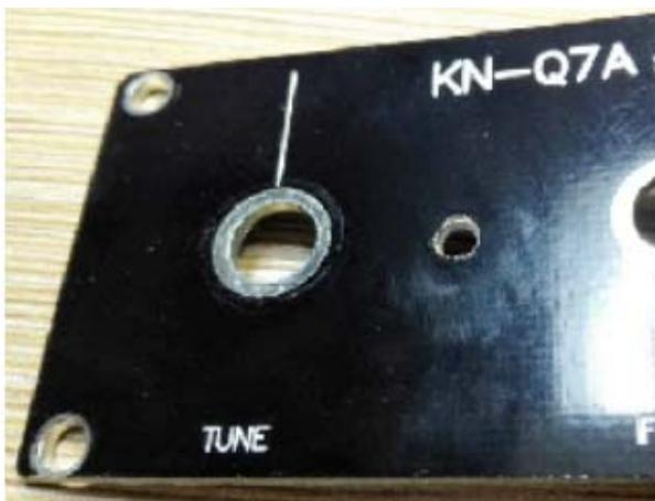
3mm径の穴を TUNE, GAIN ポテンシヨの中間に開けます。TUNE ツマミは再利用できますが、GAIN ツマミと同じ小径のものに変えるのもよいでしょう。
