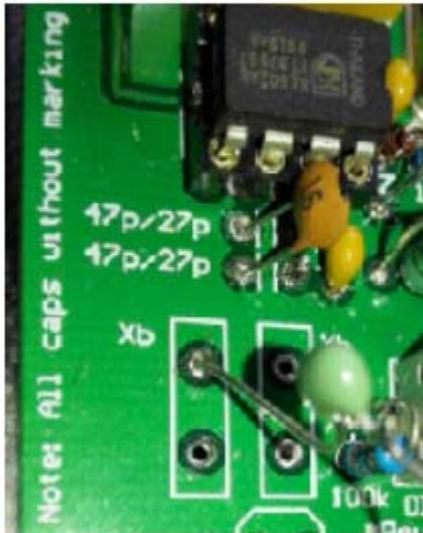
104 コンデンサを介して JP9（添付画像の右側）を BF0（Xa' の片側で画像に示す）、JP7（添付画像の左側）を VFO（Xb のピンの片側、添付画像に示す）に接続します。短い線を用いて JP8 からメイン基板適所に対して GND を結線することにより接地をより改善することができます。15pF を左図のように NE602 の近くに接続することによりプリアスを改善することができます。この追加作業は任意で行ってください。
