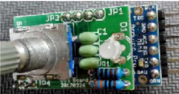
コントロール基板を Arduino 基板の表面に重ねます。
