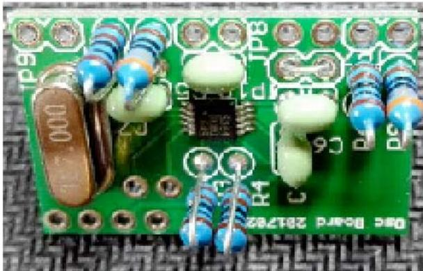
OSC 基板の製作。IC は取り付け済み。この機にハンダ不良がないかループで確認する
